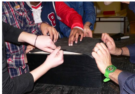
Découpe et assemblage de la membrane souple en silicone
